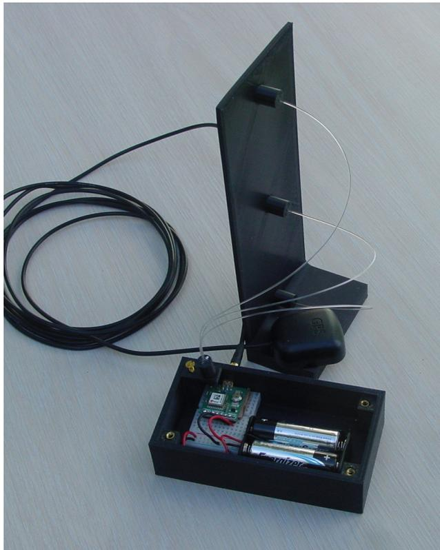
Par rapport au dispositif décrit en 2022, les LED ont été remplacées par trois fibres optiques en PMMA de 1 mm de diamètre. Pour capter la lumière, celles-ci sont placées juste au dessus de la LED 1PPS .
