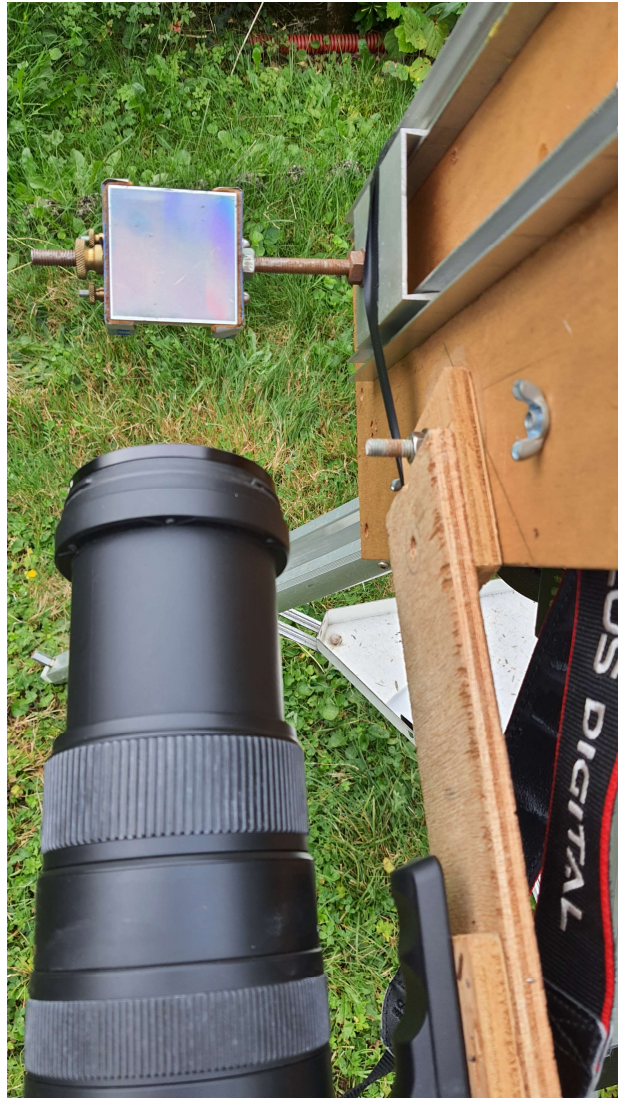
Spectro réseau blazé objectif 1200t/mm 58mm (Jobin & Yvon Horiba) objectif de 400mm
