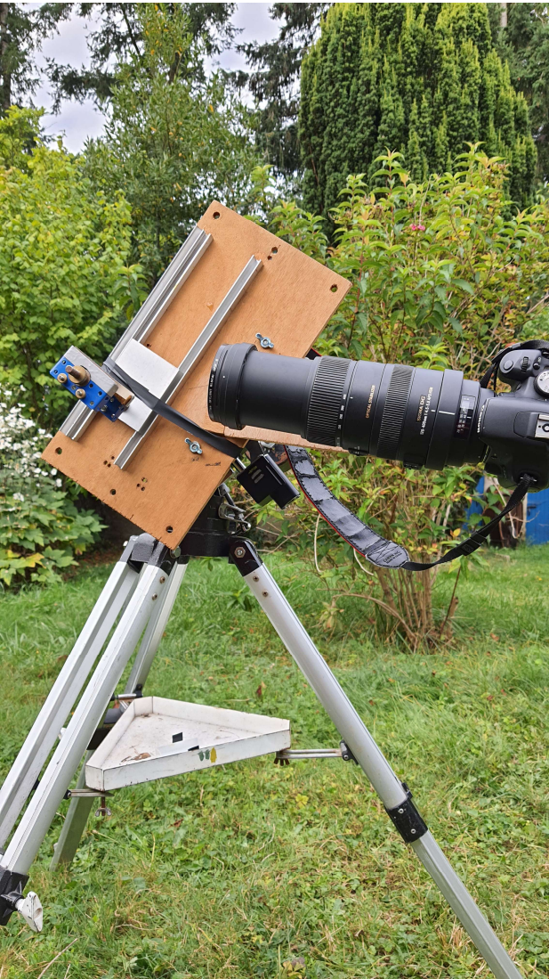
Spectro réseau blazé objectif 1200t/mm 58mm (Jobin & Yvon Horiba) objectif de 400mm
