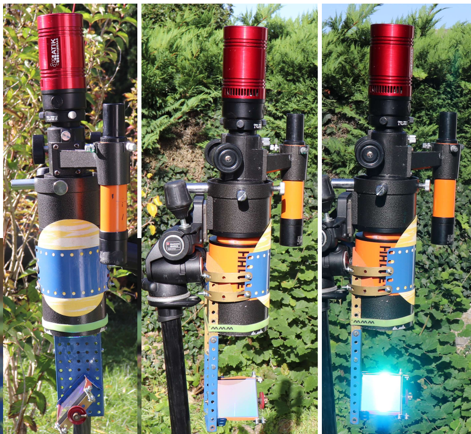
Spectro réseau beam splitter objectif 1500t/mm 58mm (Jobin & Yvon Horiba) lunette 70mm focale 400mm Thierry Midavaine
